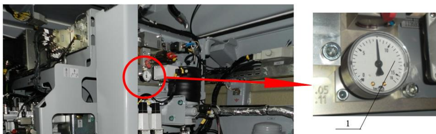
Рисунок 18.9 – Расположение манометра на вспомогательной тормозной панели:
