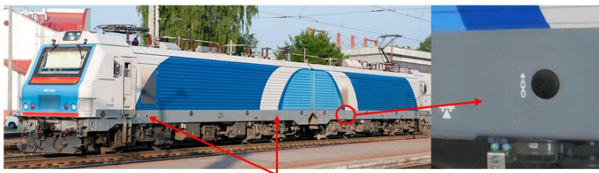
Рисунок 21.2 – Места для установки подъемных кронштейнов
