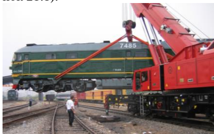
Рисунок 21.1 – Подъем кузова электровоза при помощи кранов
