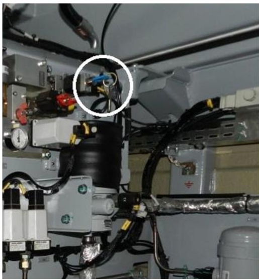
Рисунок 5.11 – Место расположения синего ключа (U99) шкафа тормозной аппаратуры
