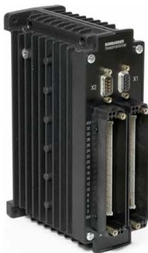
Рисунок 6.5 – Модуль ввода/вывода аналоговых данных AX1 (AX2)
