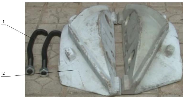
Рисунок 21.6 – Общий вид накаточного башмака типа S-1 с фиксаторами: 1 – фиксаторы; 2 – накаточный башмак
