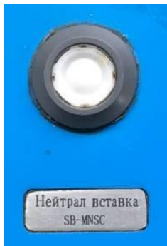
Рисунок 7.26 – Кнопка управления прохождением нейтральных вставок
