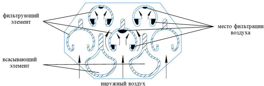
Рисунок 8.14 – Схема центробежного фильтра
