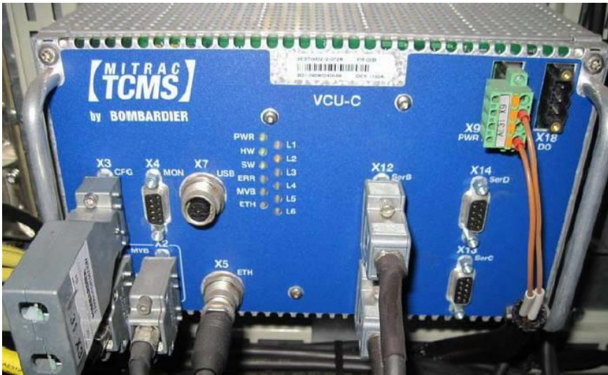
Рисунок 6.3 – Модуль VCU компьютеризированной системы управления TCMS
