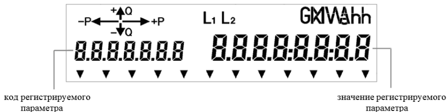
Рисунок 18.15 – Интерфейс экрана счетчика электрической энергии типа LEM
