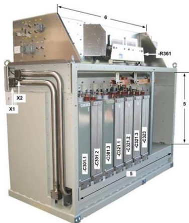
Рисунок 6.12 – Размещение оборудования в блоке тягового преобразователя (вид сзади):
