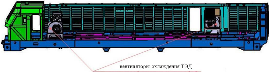
Рисунок 8.5 – Место установки вентиляторов охлаждения ТЭД
