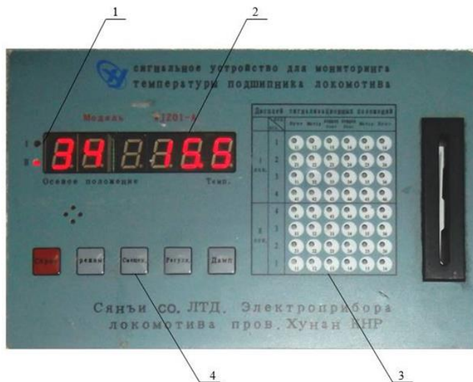
Рисунок 13.2 – Модуль мониторинга температуры подшипников:
