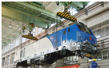
Рисунок 21.1 – Подъем кузова электровоза при помощи кранов
