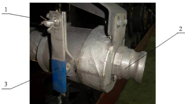
Рисунок 17.9 – Сливной патрубок бака отходов:
