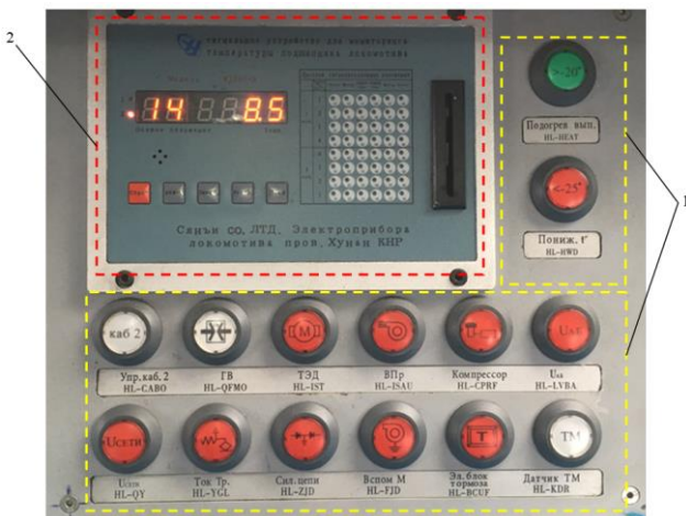
Рисунок 7.4 – Панели индикаторных ламп и контроля температуры подшипников механической части электровоза:
