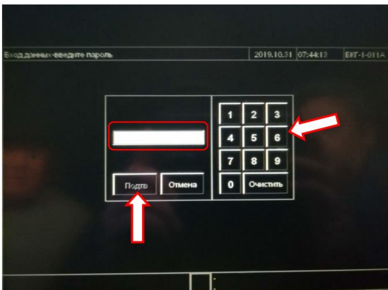
Рисунок 19.14 – Ввод пароля на вкладке «Ввод данных» дисплея МСУД 4 Нажать «идент-код секции» (рисунок 19.15);
