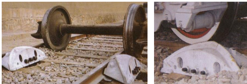
Рисунок 21.7 – Установка накаточных башмаков для возврата колесной пары в рельсовую колею
