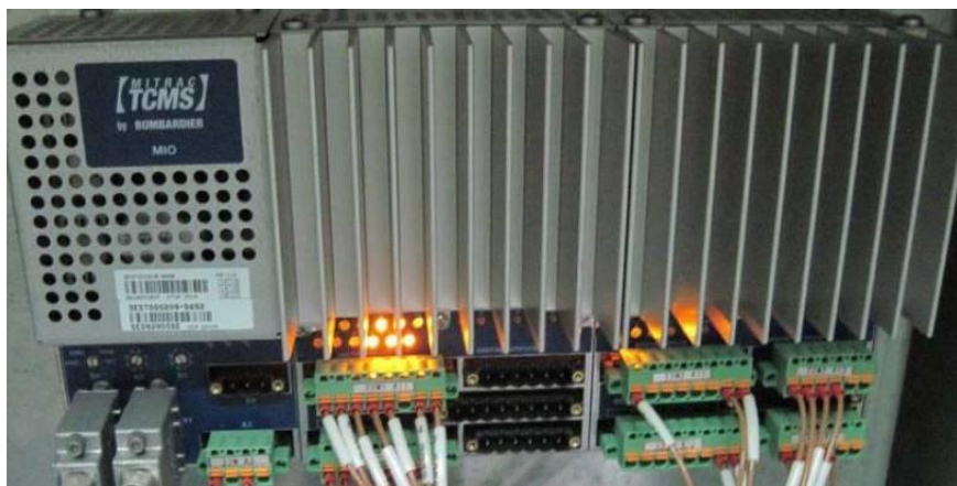
Рисунок 6.4 – Модуль ввода/вывода цифровых данных DX41 (DX42)
