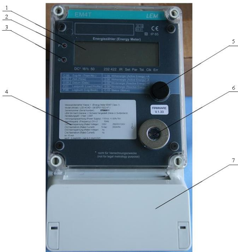
Рисунок 15.1 – Счетчик электрической энергии EM4T:
