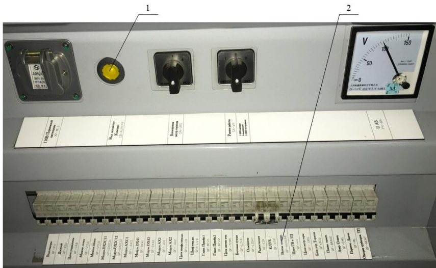
Рисунок 18.10 – Расположение кнопки пуска и автомата вспомогательного компрессора на блоке МСУД:
