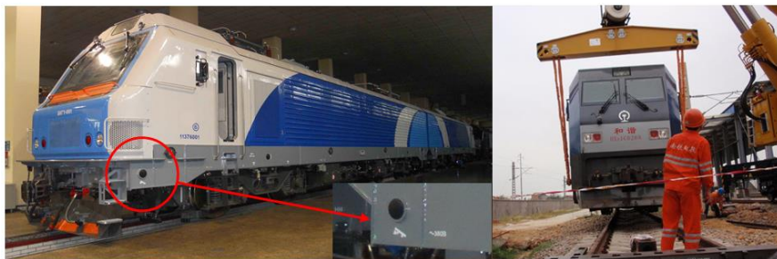
Рисунок 21.5 – Место установки кронштейна для подъема секции электровоза с одного конца
